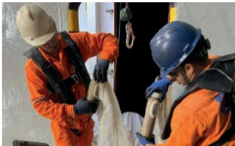
Procedimentos de concentração de amostras e retirada dos copos após lavagem da rede bongô de 330 µm e 500 µm para arrasto de ictioplâncton. Fonte: CLS Brasil.
